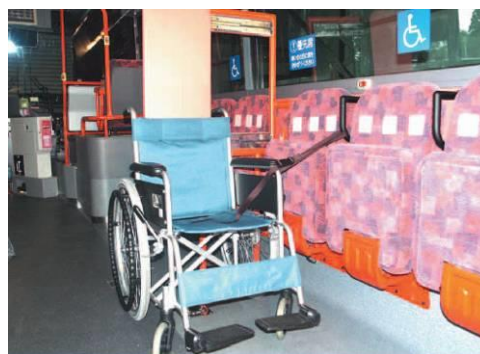
後ろ向き・背もたれ板式車いす固定装置 横ベルトで車いすを固定 (写真は国土交通省の試作試験車)
